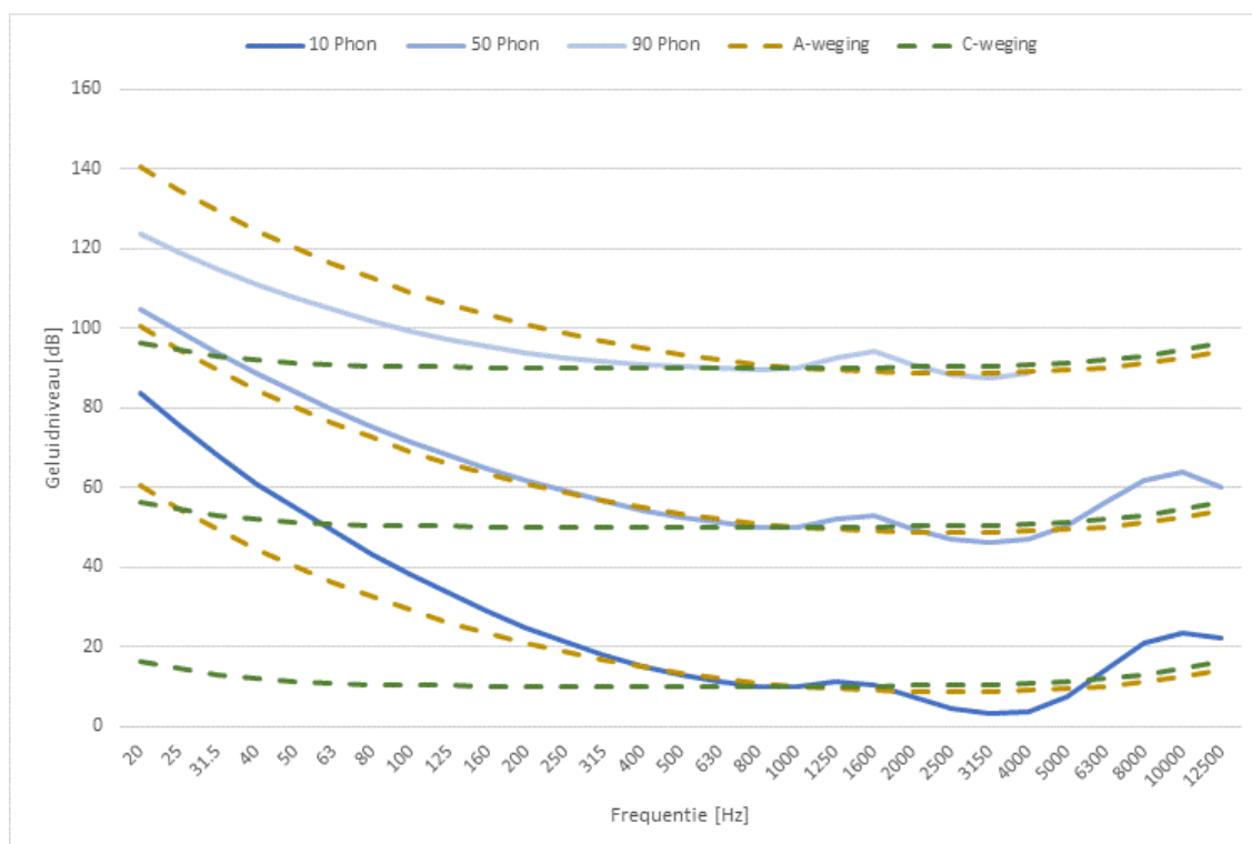
Figuur 11 Curves van gelijke luidheid van 10, 50 en 90 Phon en de daarop gefitte A-weging en C-wegingscurves
